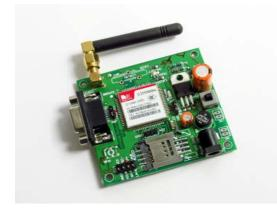
Fig. 2. GSM Module
